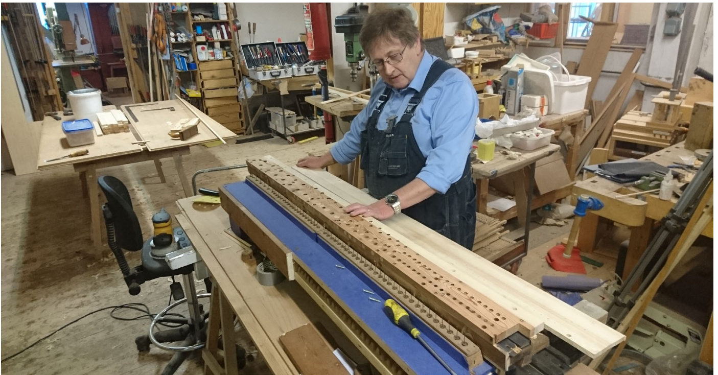
Orgelbygger Henrik Brinck Hansen fra Dokka konsentrerer seg først om "Vindladen" som er hjertet i orgelet. Det er her luften fordeles til alle pipene, og her må det ikke være lekkasjer.
