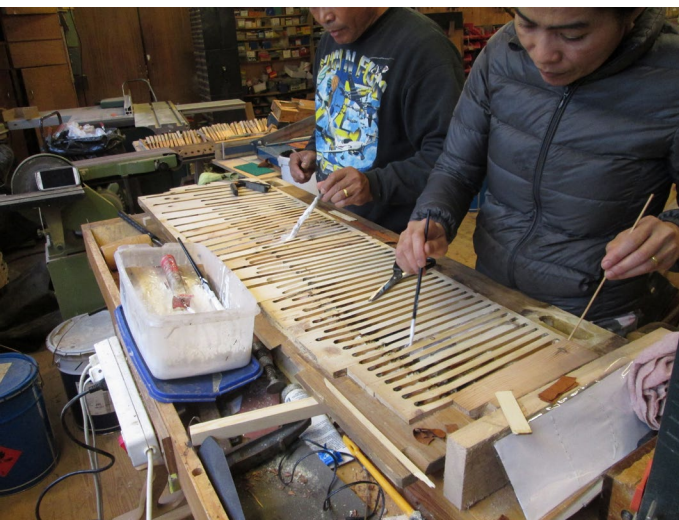
Over 50 smale ganger i flere etasjer skal tettes møysommelig med lim.
