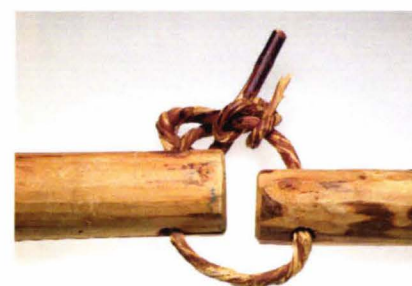
MODELL AV LENSEKOPPEL med vidjespenning.
