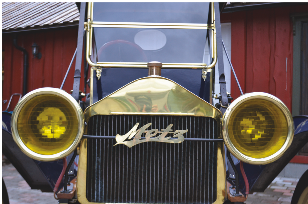
Fronten på Metz-en, med lyktene drevet av karbid (som de gamle gruvelyktene) og navnet i grillen. Foto forf.
