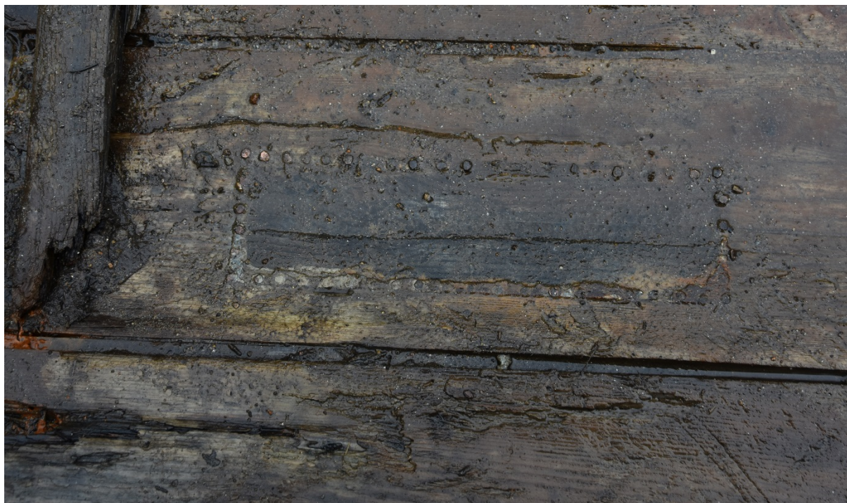
FIG 10 REPARASJON MED KOBBERSPIKER I BUNNEN AV PRAMMEN
