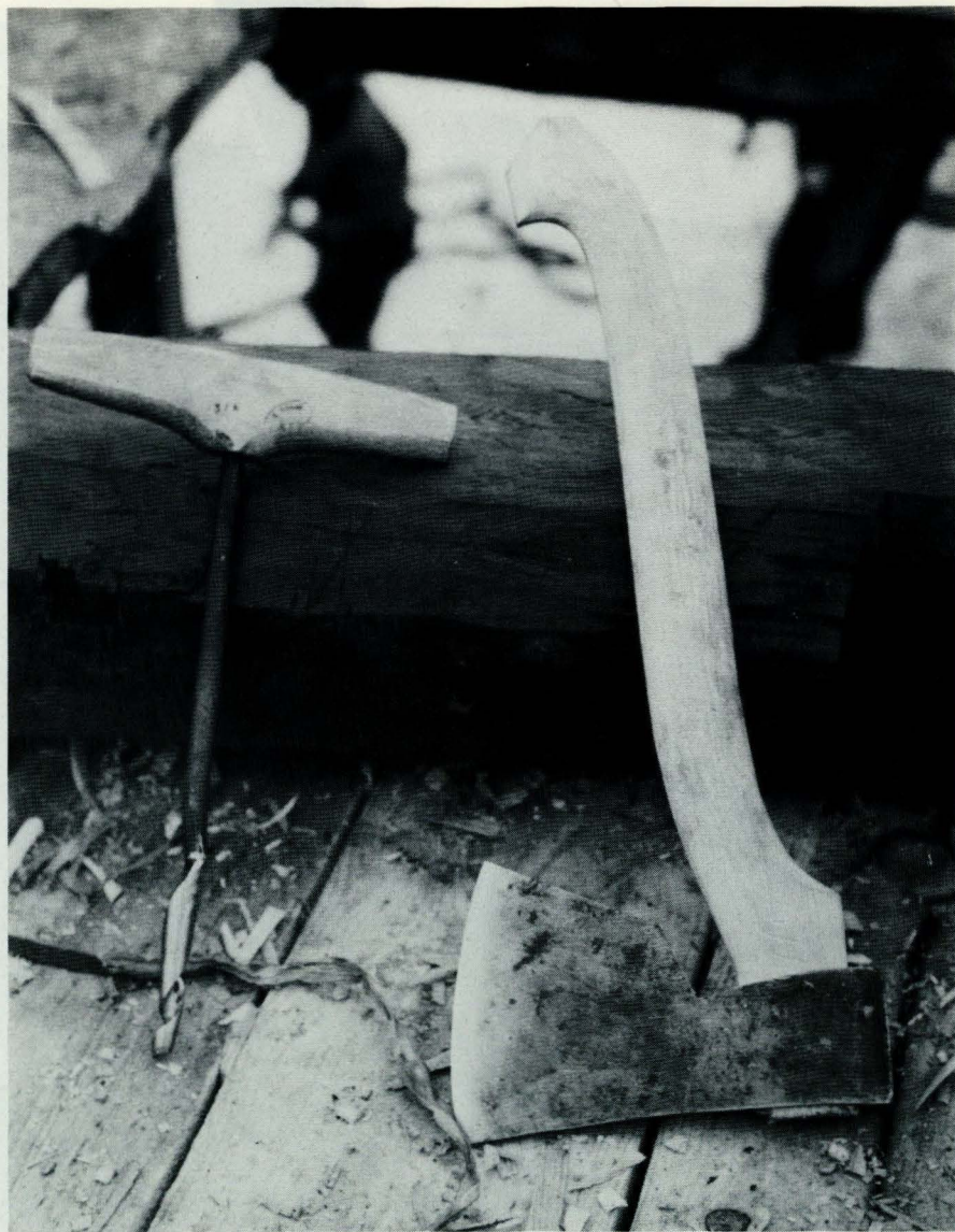
Godt verktøy er viktig, bile med skaftmodell fra Telemark, navaren er spesialsmidd av Edvin Odland, Frekhaug, nord for Bergen. Taktro, golv og skjøting m.m. er satt fast med plugger. (66383).
