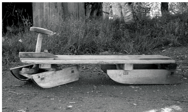
Hjemmelaget rattkjelke fra 1940-50. Styremekanismen som er koblet til rattet er utformet av et selvvokst emne. Foto: Anne-Lise Reinsfelt, Norsk Folkemuseum
