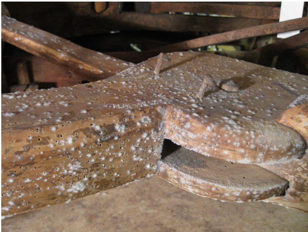
Figur 7. Mögel på en träartefakt i fuktiga förhållanden. Friluftsmuseet, Sorgenfri, Danmark. Foto: Morten Ryhl-Svendsen (CC BY-NC-ND).
