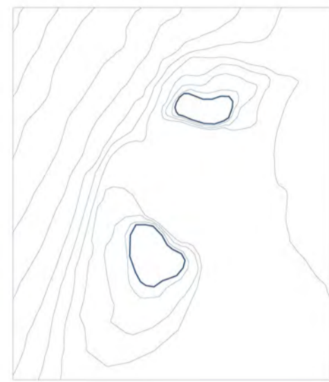
Bakkens udtryk forstærkes ved at forhøje dens toppe med materiale fra graveprocessen.
