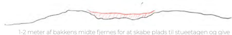
1,2 meter af bakkens midte fjernes for at skabe plads til stueetagen og give universel adgang.
