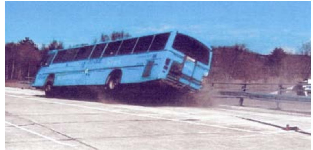
Stor krefter var i sving når en buss skulle testes i kollisjon med et H2 rekkverk. (Foto: Arnulf Ingulstad)
