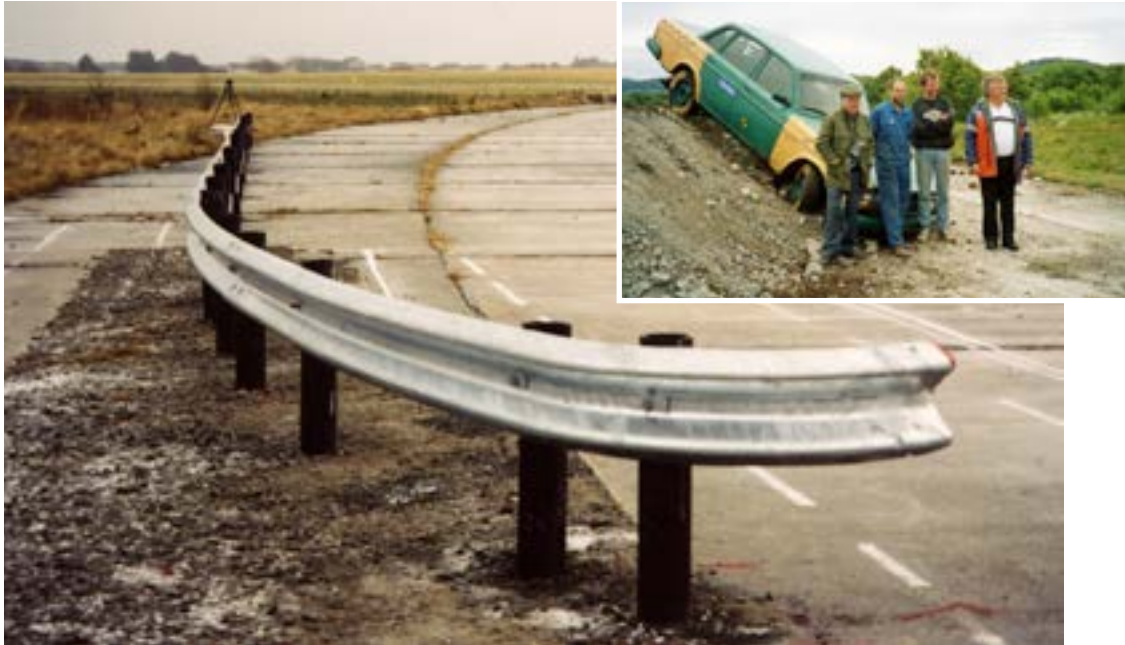
Ettergivende rekkverksende utviklet av Vegdirektoratet. Ved utprøvingen kunne det gå hardt for seg. (Foto: Arnulf Ingulstad)
