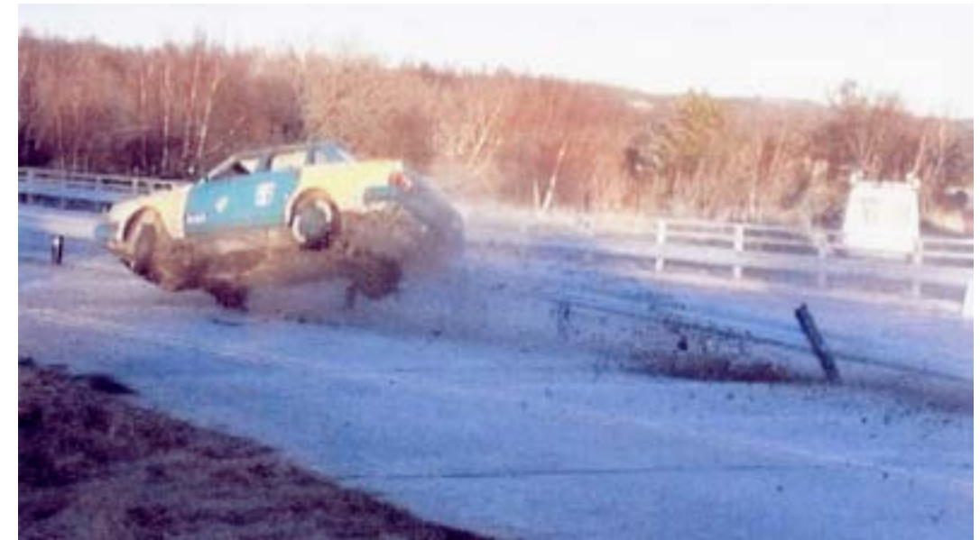
Nye tester måtte til. Her kollisjon med et N2 rekkverk på Lista. (Foto: Arnulf Ingulstad)
