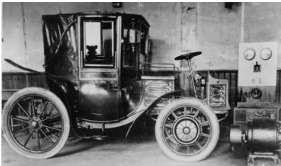
Lohner 1903 fotografert på Arthur Bjerkes verksted. Merk at motoren er bygd inn i forhjulsnaget. (Foto fra Norsk Teknisk Museum)
